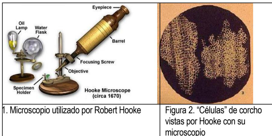
El microscopio óptico, el tipo usado en casi todos los colegios, consiste en un tubo con lentes de aumento en cada extremo. (Dado que contiene varias lentes, este instrumento a veces se denomina microscopio compuesto.) El principio es muy simple: por el objeto que se observa y por las lentes pasa luz visible. Las lentes refractan (desvían) la luz, con lo que la imagen se amplifica.
